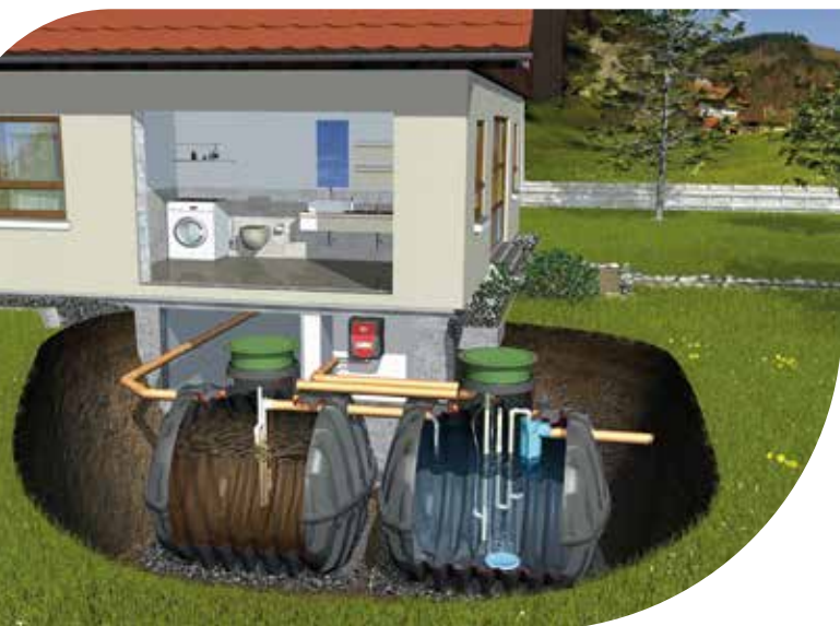
Systeme d'assainissement en micro-station.
